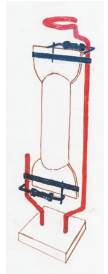
Tehničke pojedinosti: Okrugle cijevi crvene boje (54 mm), plosnato željezo (5x50 mm), puno okruglo željezo crne boje (10 mm), visina 260 cm
